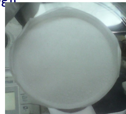
Forma elektrolitu polimerowego: elastyczna membrana/folia
